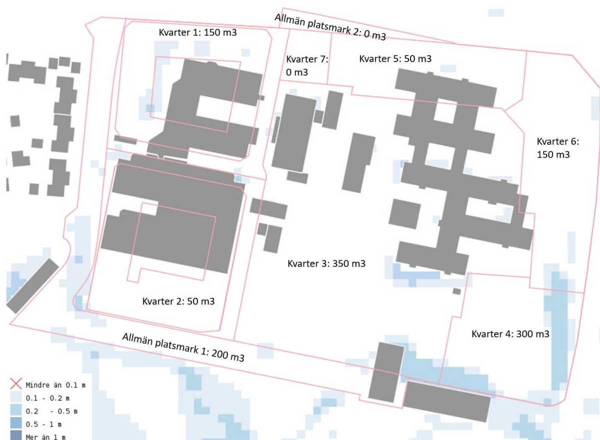
Figur 5. Blå områden visar vattendjup vid skyfall i området. Mörkare blå färg innebär större vattendjup. För vattensamling framgår vattendjup samt volym. Vattendjupet varierar 0,1–0,5 m med störst vattendjup längs sydöstra plangränsen (kvarter 4).
