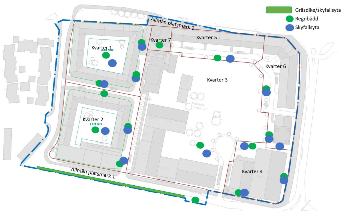
Figur 1. Område B med allmän platsmark och kvartersmark (kvarter 1–7). Dagvattenrening, fördröjning och hantering av skyfall behövs och placering av föreslagna anläggning framgår översiktligt.
