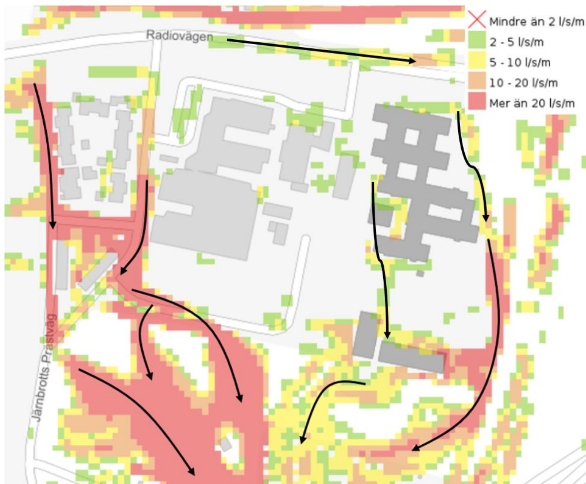
Figur 8. Befintliga avrinningsvägar vid ett klimatanpassat 100-års regn. Bild och information hämtad från Gokart 2022.
